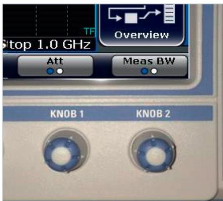
Выбор параметров для назначения функций для поворотных кнопок.
