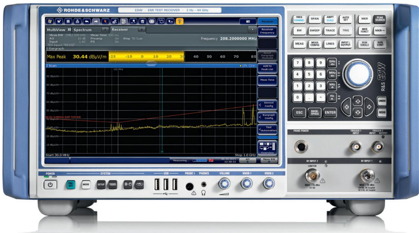
R&S®ESW оснащен следующими типами детекторов: квазипиковым, среднеквадратическим с усреднением (с заданной постоянной времени) и CISPR-детектором среднего значения, а также обычными пиковыми (мин. и макс.), среднеквадратическими детекторами и детекторами среднего значения и функцией распределения вероятности амплитуд (APD).
