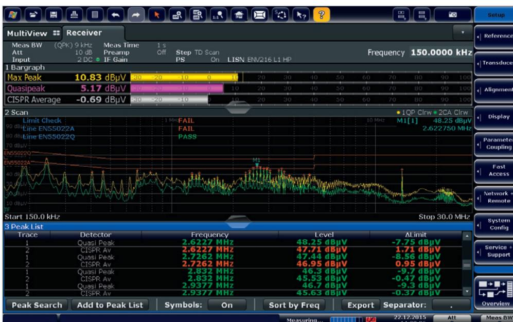
В режиме анализатора спектра R&S®ESW производит измерения с разрешением до 200 001 точек. В стандартном режиме измерительного приемника с любой шириной шага воспринимаются и сохраняются до 4 миллионов точек измерения на кривую.
