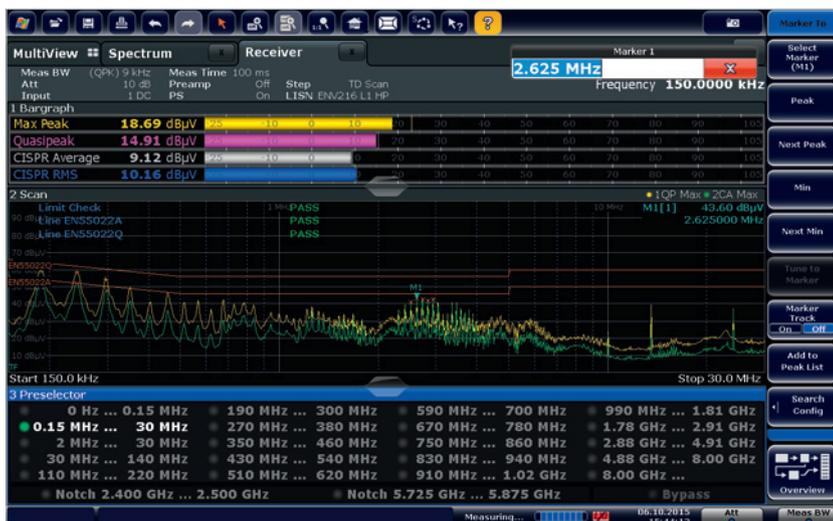
Измеряемая кривая с отображением активного фильтра предварительной селекции.
