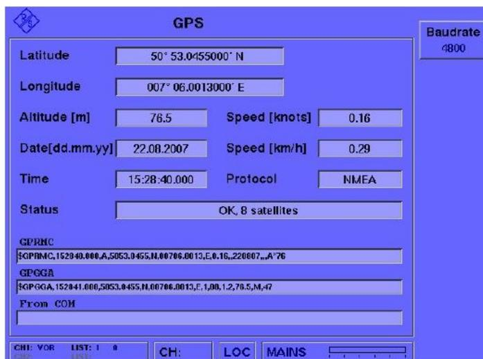
Рисунок 35 – Опция R&S® EVS-K2 (GPS) с подключением по последовательному порту RS-232 к внешнему GPS-устройству
