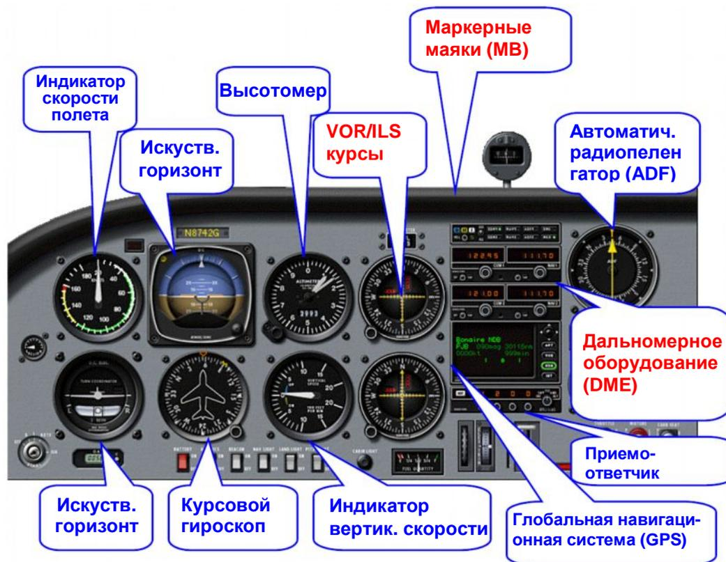
Рисунок 2 – Вид различных приборов для навигации и посадки в кабине воздушного судна
