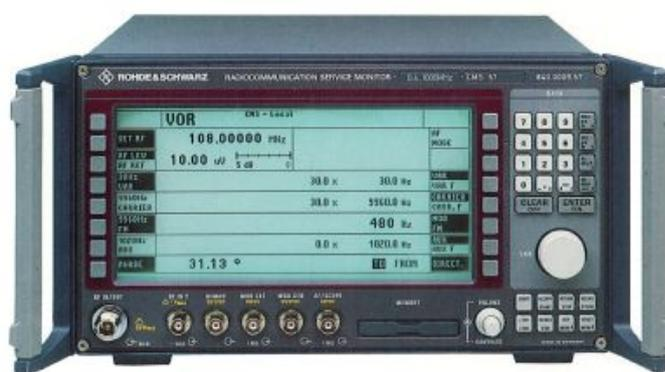
Рисунок 42 – Радиокommunikационный сервисный монитор R&S®CMS57
