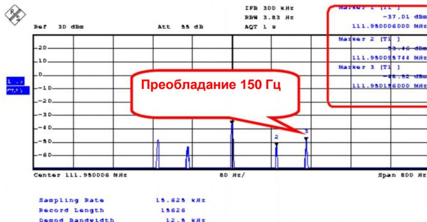
Рисунок 27 – Опция аналоговой демодуляции R&S®FS-K7: ВЧ-спектр сигнала ILS с несущей и преобладающей частотой 150 Гц
