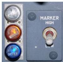
Рисунок 15 – Аудиовизуальная сигнализация маркерных радиомаяков
