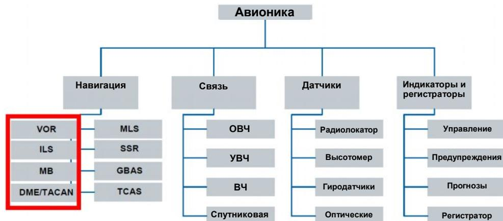
Рисунок 1 – Простейшее структурное разбиение авионики с упором на **выделенные** навигационные системы
