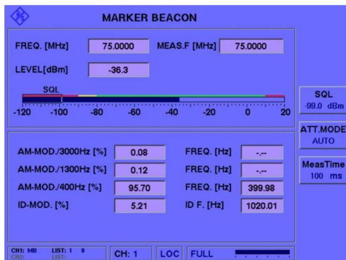
Рисунок 34 – Маркерный радиомаяк анализатора R&S®EVS300 с выходом звуковой частоты и авторегулировкой громкости
