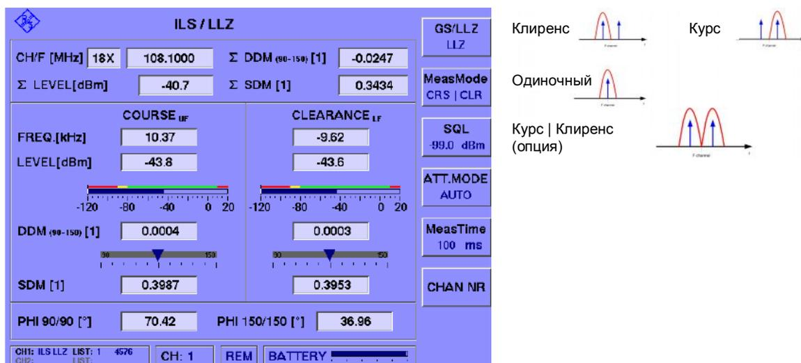
Рисунок 36 – Режим работы курс/клиренс (CRS/CLR) опции R&S®EVS-K3 и его графическое представление
