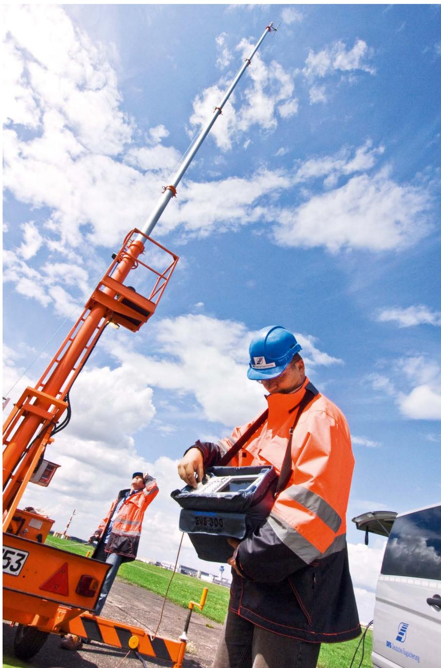
По удобству эксплуатации анализатору R & S®EVS300 нет равных, это идеальный выбор для проведения измерений глассады на взлетно-посадочной полосе.
